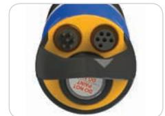
电源接头、电池仓盖和用于连接额外传感器的扩展接口
